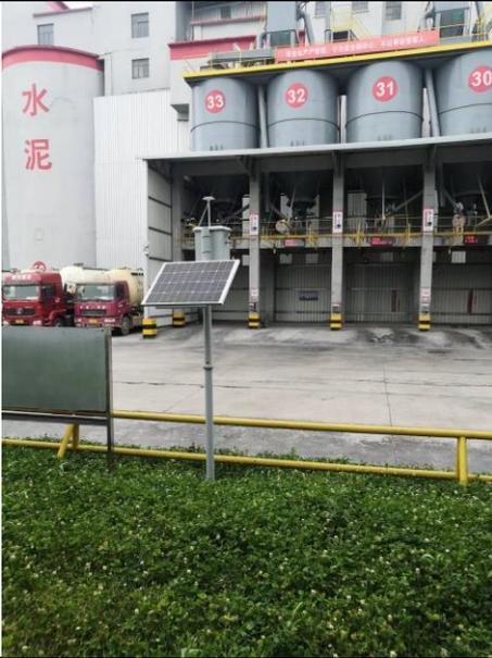
2# 1#线散装发放空气质量监测微站
